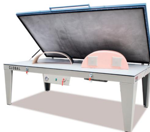
La GMP-S est une presse à Membrane économique sans renoncer à la qualité. Elle vous permettra également de plaquer, laminier et cintrer des panneaux de bois allant jusqu'à 50mm d'épaisseur. Elle est équipée d'une pompe à vide au fonctionnement continu qui est protégée par un filtre à air de 60 microns.
